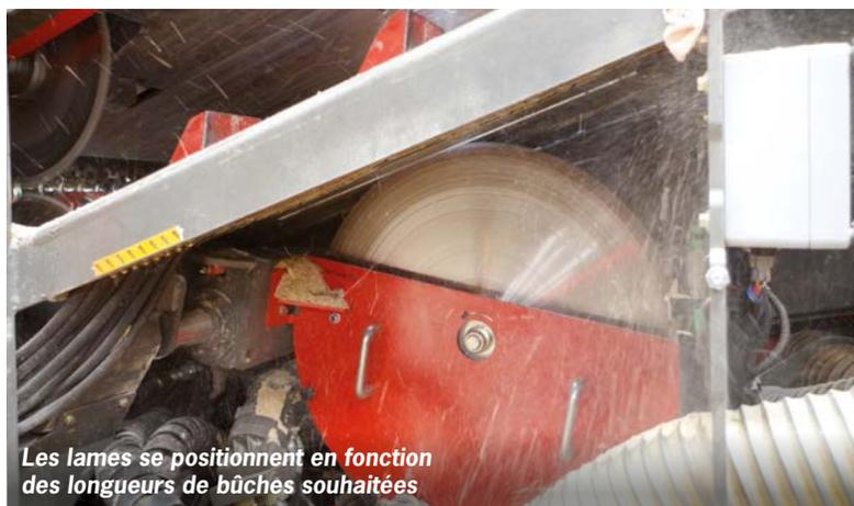
Les lames se positionnent en fonction des longueurs de bûches souhaitées
